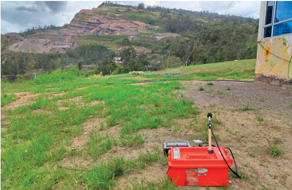
Imagen. Instalación de sismógrafo y sonómetro en vivienda Sr. Vicente Mondragón, vereda Timasita.
